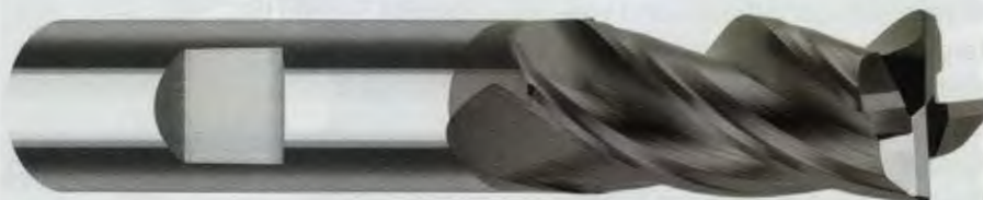
Bild 2: Ein Beispiel aus der breiten Werkzeugpalette zum Einsatz in der Luft- und Raumfahrt: Der VHM-Schaftfräser Flutemax liefert dank spezieller Kantenpräparation in Verbindung mit der Mikrogeometrie sowie ungleicher Teilung, ungleichem Drallwinkel, Formnut und polierter Varocon-Hochleistungsschicht in schwer zu zerspanenden Materialien wie-Inox, Titan, Inconel und Nimonic sehr gute Ergebnisse ab
