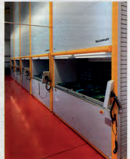
Bild 2: Die leistungsfähigen Vertikallifte (Werkbilder: Inovatoools Eckerle & Ertel GmbH, Kinding-Haunstetten)
