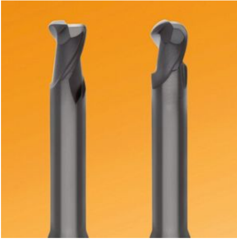
Mit Diamant beschichtete VHM-Schaftfräser mit Eckenradius und mit Vollradius zum Fräsen von Elektroden aus Grafit. (Bild: Inovatools Eckerle & Ertel GmbH)
